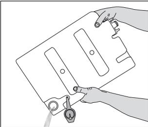
3. Falls sich Fusseln im Trichter des Wassertanks angesammelt haben sollten, entfernen Sie diese unter fließendem Wasser.
