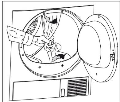
**⚠** Sorgen Sie dafür, dass die Transportsicherungen (Kunststoff- und Schaumstoffteile) vor der ersten Nutzung des Gerätes vollständig entfernt werden. Lassen Sie nichts in der Trommel zurück.
