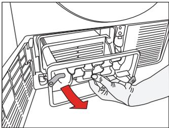
4. Reinigen Sie den Kondensator unter einem kräftigen Wasserstrahl (z. B. mit dem Duschkopf), lassen Sie das Wasser komplett ablaufen.
